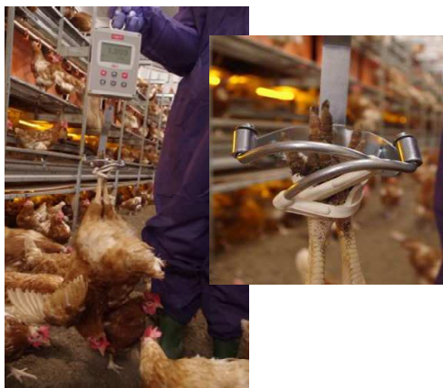
Abb. 2: VEIT Hängewaage und Klemmhaken mit Gummi. Diese Waage wurde im Projekt verwendet. Die Hennen werden für kurze Zeit kopfüber mit den Füßen im Klemmhaken fixiert. Die Tiere können ruhig und zügig gewogen werden.
